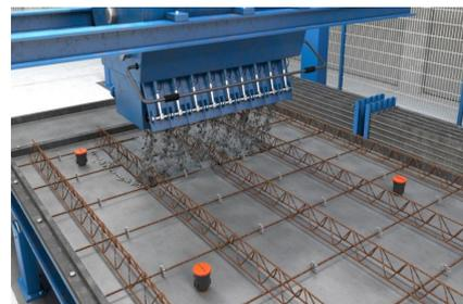
Stahlarmierung legen und das Fertigteil betonieren. Nach der Betonage bleiben die Magneten auf dem Schaltisch.
